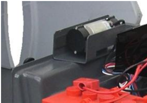
Moteur secoueur de filtre protégé contre la poussière
