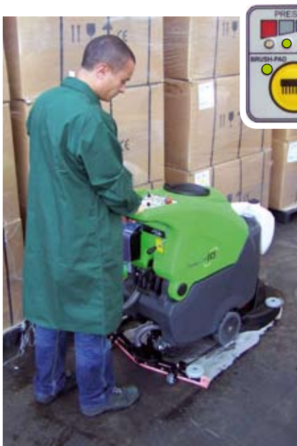
Herkömmliche Bürsten oder Pads (200 g/m / 1,1 – 1,5 l/min)
