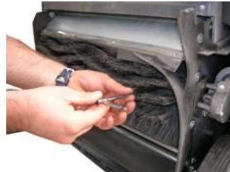
Die Maschine kann leicht auf eine Seite gekippt werden, um die Hauptkehrwalze auszuwechseln und den Raum zu überprüfen.
